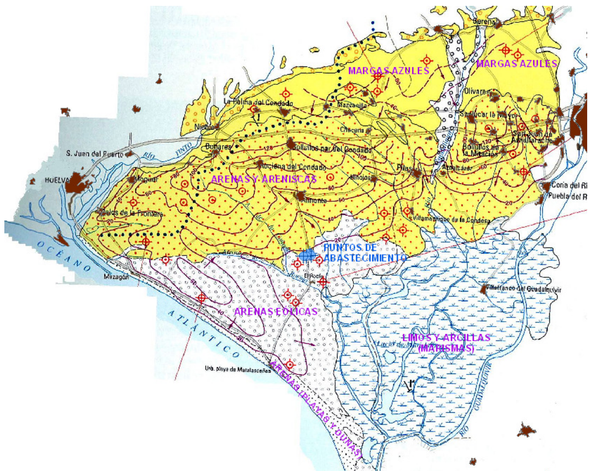
Fig. 2 Esquema hidrogeológico de la MAS 05.51 "Almonte Marismas".
